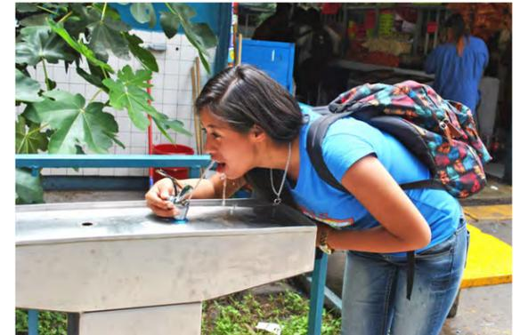
Cabe destacar que los bebederos cuentan con un sistema potabilizador y permite que su consumo no traiga ningún riesgo; es conocido como bebedero isla y consta de un pre filtro de resina de polipropileno compactado, de 5 micrómetros, y un filtro con membrana de 0.2 micrómetros para la reducción de bacterias, sedimentos y cloro, y está certificado y homologado por la Comisión Federal para la Protección contra Riesgos Sanitarios (Cofepris).
