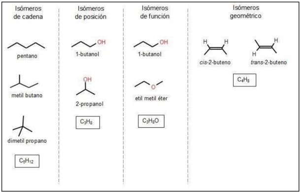
Imagen 10. Ejemplos y estructuras de diferentes isómeros.
