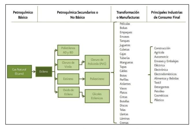
Imagen 2. Se muestra la integración del etileno (un petroquímico básico) en una cadena de producción. Obtenida de:
