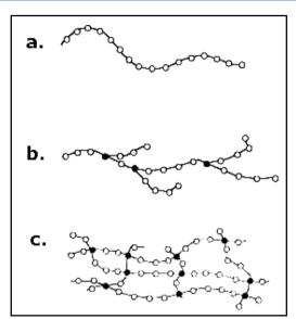
Imagen 29. Diferentes cadenas poliméricas. En (a) una cadena lineal, en (b) una cadena ramificada y en (c) una cadena entrecruzada. Obtenida de: <a href="https://quimplast.files.wordpress.com/2015/05/arquitecturamolecular2.gif">https://quimplast.files.wordpress.com/2015/05/arquitecturamolecular2.gif</a>
